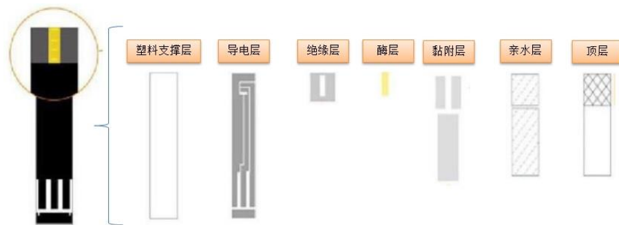
图 15 顶吸式血糖试纸结构分解示意图
